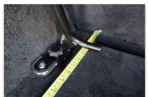
Befestigen Sie die Verbindungen an den Verzurrösen
